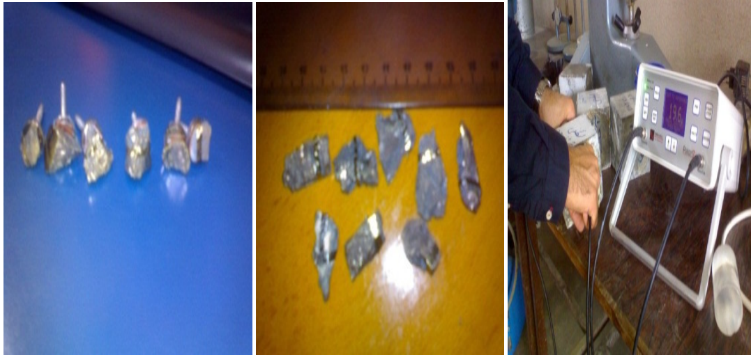
شکل ۳- نحوه قرارگیری مولدها (راست) ابعاد و مشخصات نمونه‌ها جهت آزمایش SEM پس از روکش طلا (چپ)
