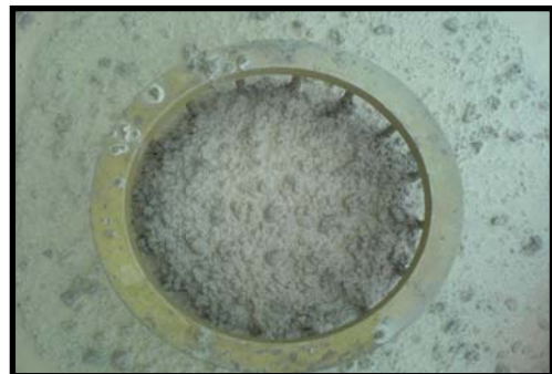
شکل ۲- آزمایش حلقه L، مربوط به طرح c، کاهش قابلیت عبور و محصور شدن سنگ دانه ها در میان آرماتورها و عبور خمیر سیمان به تنهایی در مسیر جریان
