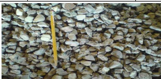
شکل ۱- تصویری از سنگ‌دانه‌های بازیافتی درشت‌دانه مورد استفاده در آزمایش جدول ۴- مشخصات طرح اختلاط‌های بتن خودتراکم با به‌کارگیری مصالح بازیافتی
