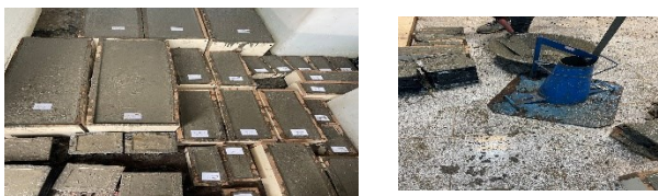
د) آزمایش اسلامپ بتن ه) نحوه قالب بندی تیرهای بتنی
