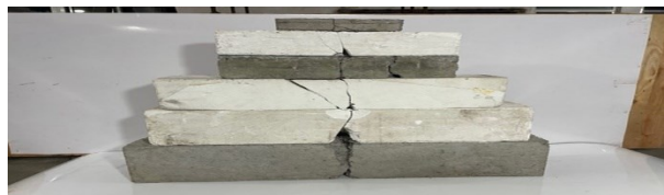
شکل ۱۵- انتشار ترک و رفتار شکست نمونه اصلی و نمونه های آزمایشی ۱ تا ۵ براساس جدول (۶).
