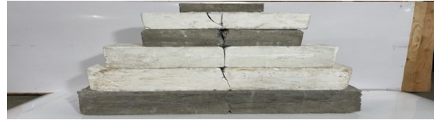
شکل ۱۲- انتشار ترک و رفتار شکست نمونه اصلی و نمونه‌های آزمایشی ۱ تا ۵ براساس جدول (۵).
