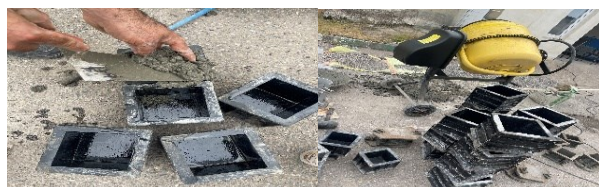
ب) مخلوط بتن در همزن ج) قالب های مکعبی و بتن موجود در آن
