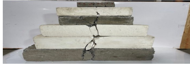
شکل ۱۸- انتشار ترک و رفتار شکست نمونه اصلی و نمونه های آزمایشی ۱ تا ۵ براساس جدول (۷).
