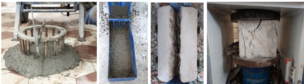
شکل ۲- برخی از تصاویر مربوط به برنامه آزمایشگاهی تحقیق (از سمت چپ به راست به ترتیب: حلقه L، قیف V، مقاومت کششی، مقاومت فشاری)
