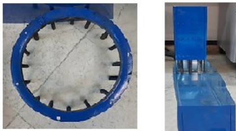
شکل ۶. دستگاه آزمایش جعبه L شکل ۷. دستگاه آزمایش حلقه J
