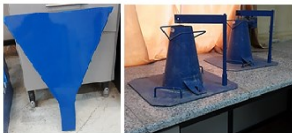
شکل ۴. دستگاه آزمایش جریان اسلامپ شکل ۵. دستگاه آزمایش قیف V
