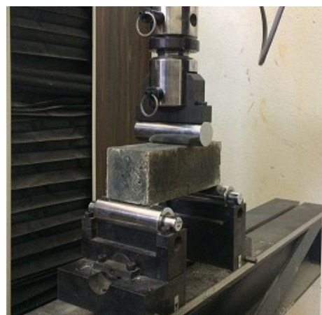
شکل ۷- آزمایش خمش بر روی نمونه های منشوری
