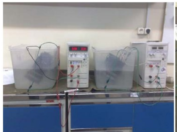
شکل ۱۰- دستگاه آزمایش مهاجرت سریع کلراید (RCMT)
