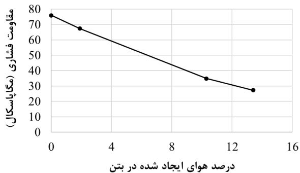
شکل ۶- رابطه بین مقاومت فشاری ۲۸ روزه و درصد هوای ایجاد شده در بتن
