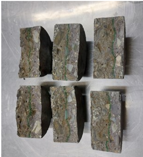
شکل ۱۱- ناحیه نفوذ یون کلراید در آزمایش RCMT
