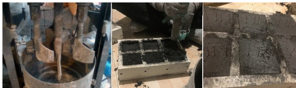
شکل ۱- میکسر مخلوط‌های غلیظ و روند تهیه نمونه‌های پژوهش
