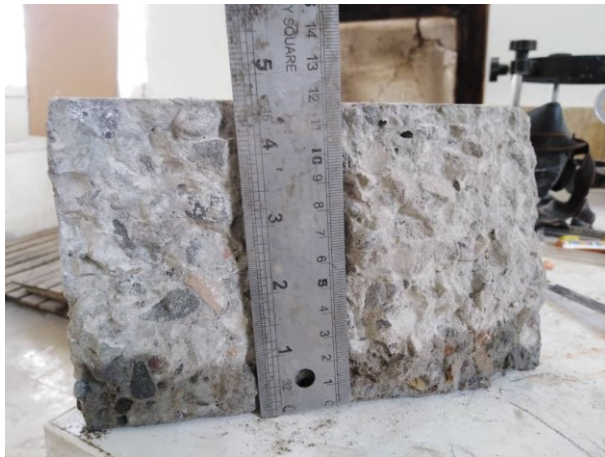
شکل ۲- نمونه بتنی پس از نفوذپذیری آب
