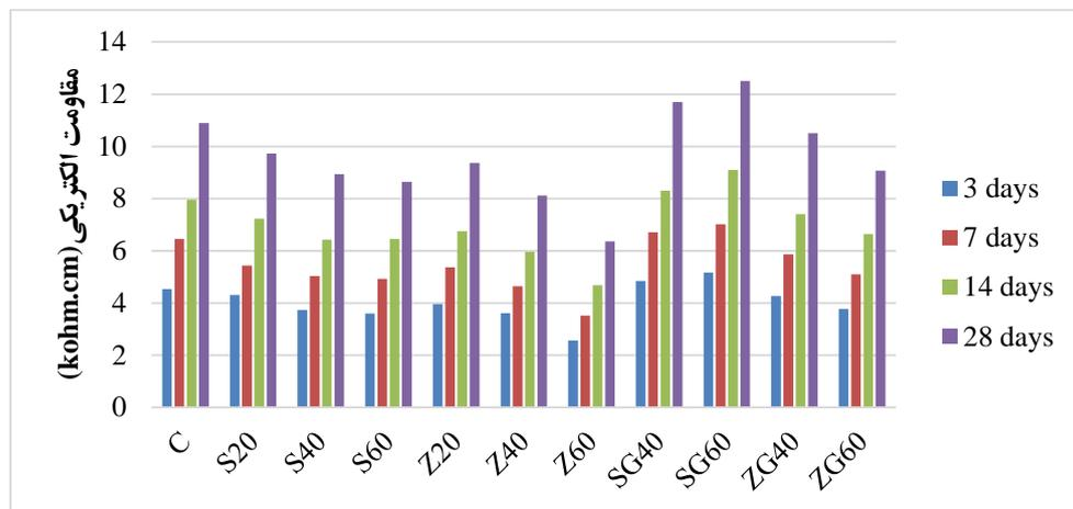
شکل ۴- مقاومت الکتریکی طرح های مختلف در سنین ۳، ۷، ۱۴ و ۲۸ روز
