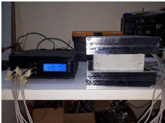
شکل ۱- سیستم اندازه گیری هدایت حرارتی و نمونه بتنی تحت آزمایش
