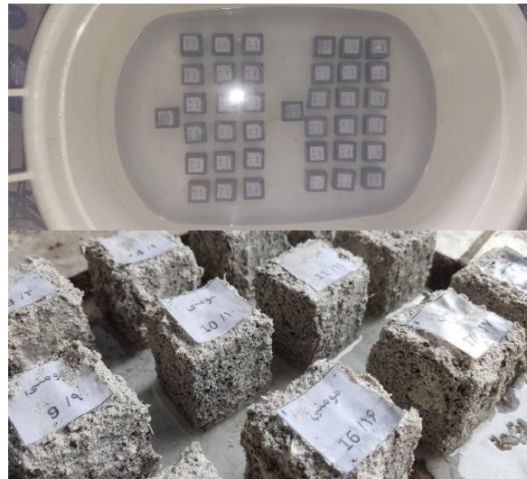
شکل ۲- نمونه قبل و بعد از قرارگیری در اسید سولفوریک
