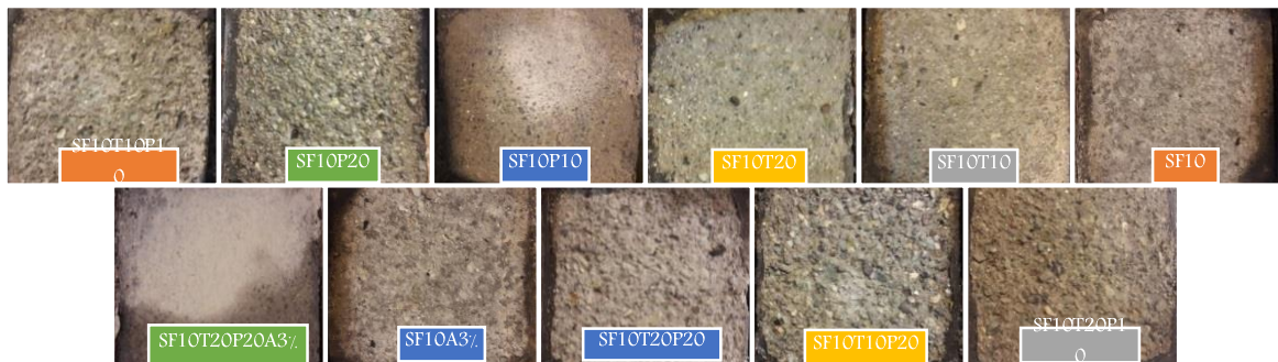
شکل ۸- نمونه‌های بتنی بعد از آزمایش پوسته‌شدگی
