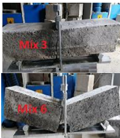
شکل ۹- نحوه شکست نمونه‌های ۳ و ۶
