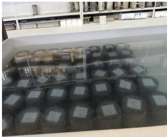
شکل ۲- قرارگیری نمونه‌ها در حوضچه آب برای عمل‌آوری
