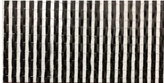
شکل ۸- شبکه الیاف CFRP
