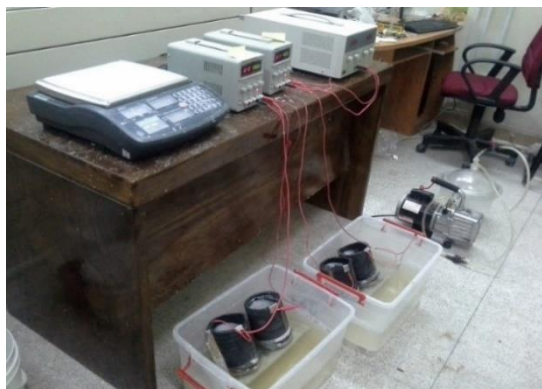
شکل ۲- نمایی از آزمایش مهاجرت تسریع شده یون کلراید
