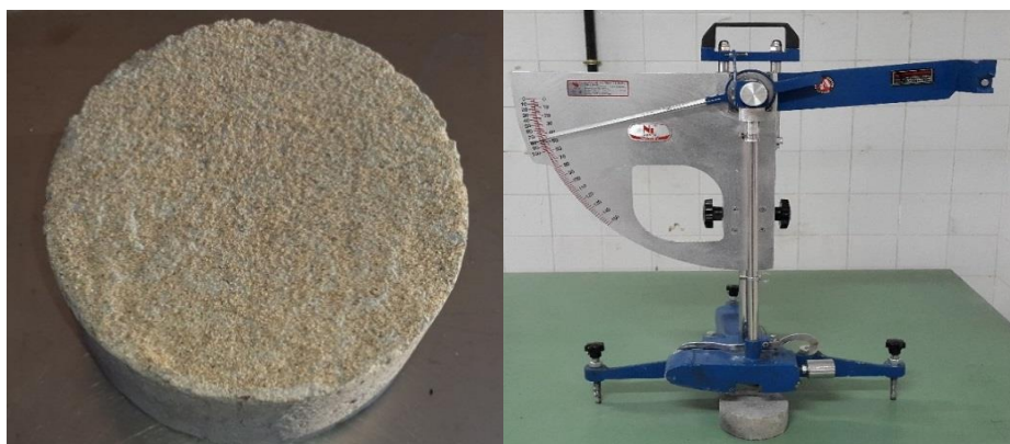
شکل ۳- پخش ماسه روی نمونه بتن غلتکی و آزمایش پاندول انگلیسی روی نمونه بتن غلتکی
