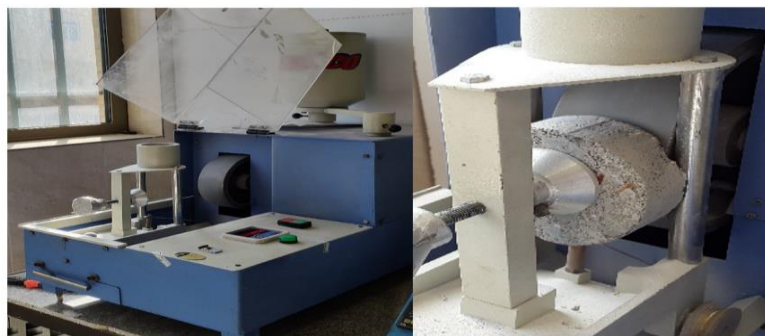
شکل ۶- آزمایش سایش چرخ پهن در دو نمای مختلف
