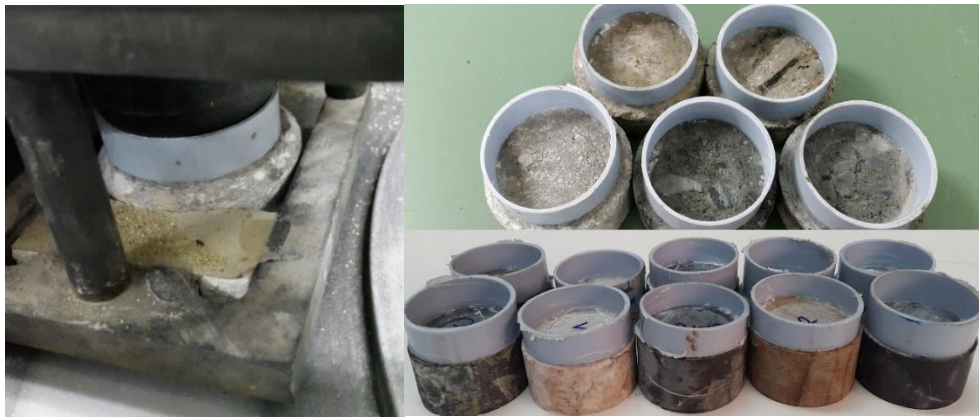
شکل ۵- نمونه‌های سایشی بتنی و سنگی مغزه گیری و قرار گیری نمونه مغزه گیری شده در دستگاه دوری تست
