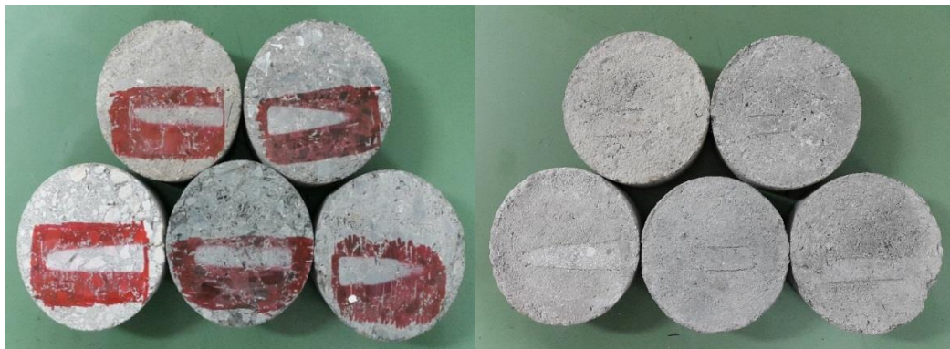
شکل ۷- سایش چرخ پهن سطح بتن عمل آوری شده معمول و سایش چرخ پهن سطح بتن برش خورده
