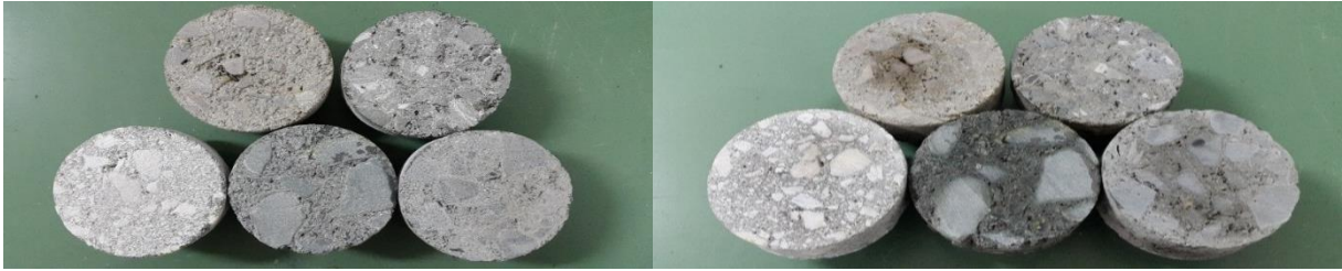
شکل ۸- مقایسه نمونه‌های بتنی قبل و بعد از سایش دوری
