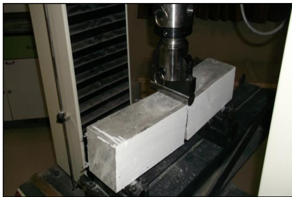
شکل ۴ - مجموعه آزمایش خمش سه نقطه‌ای تیر مستطیلی شیاردار
