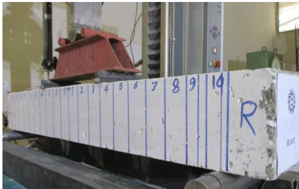
شکل ۲۳ - نمونه‌ی خمشی آماده‌ی آزمایش خمش چهارنقطه‌ای
