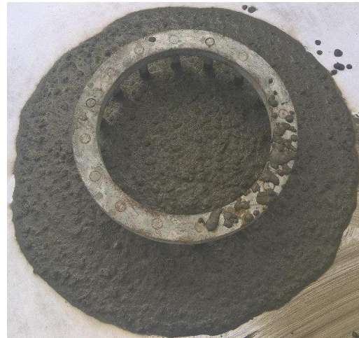
شکل ۱۲- پخش جریان بتن خودتراکم در حلقه J
