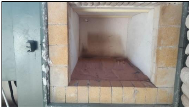
شکل ۳- فضای داخلی کوره الکتریکی
