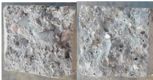
الف) رشد ترک در دمای محیط (۲۵ درجه سانتی‌گراد) ب) رشد ترک در دمای ۷۰۰ درجه سانتی‌گراد
