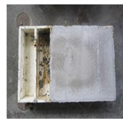
شکل ۱۱- مراحل ساخت نمونه تیر خمشی ساده
