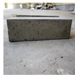
شکل ۱۱- مراحل ساخت نمونه تیر خمشی ساده
