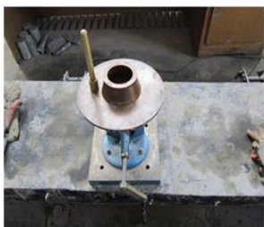
شکل ۱۳- آزمایش روانی توسط میز سیلان
