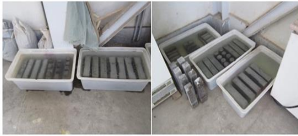
شکل ۶- حوضچه عمل آوری نمونه‌های ساخته شده در محیط آبی
