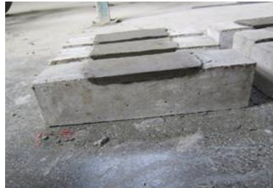
شکل ۱۴- ساخت تیر خمشی مرکب
