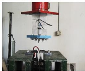
شکل ۱۲- مراحل آزمایش مقاومت تیر خمشی ساده
