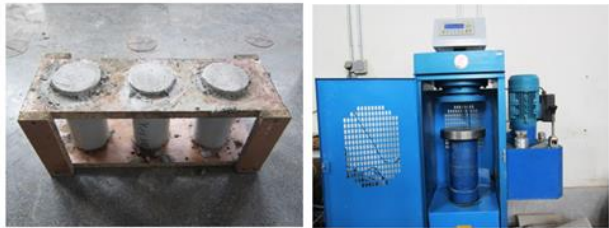
شکل ۵- مراحل ساخت نمونه استوانه‌ای و آزمایش مقاومت فشاری
