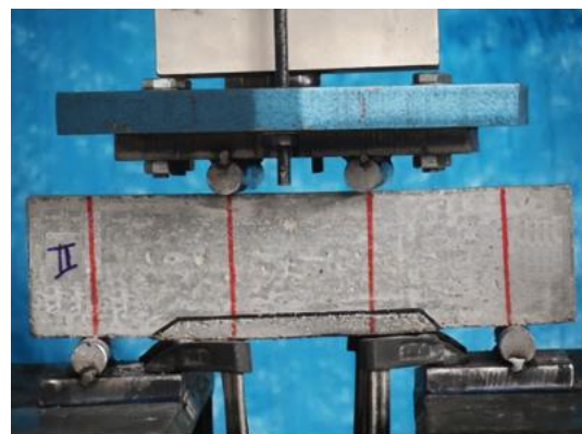
شکل ۱۵- آزمایش مقاومت تیر خمشی مرکب
