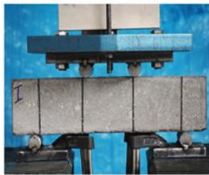
شکل ۱۲- مراحل آزمایش مقاومت تیر خمشی ساده
