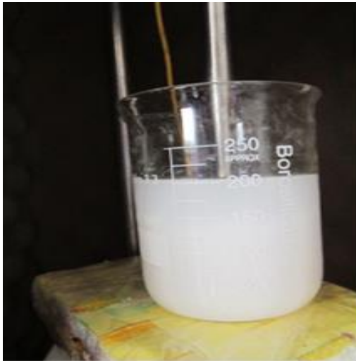
شکل ۲- پایدار کردن ذرات توسط آلتراسونیک
