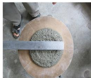
شکل ۱۳- آزمایش روانی توسط میز سیلان
