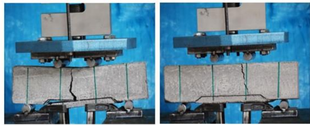
شکل ۲۸- شکست تیر مرکب همراه با جداشدگی ماده ترمیم (مود ۲)
