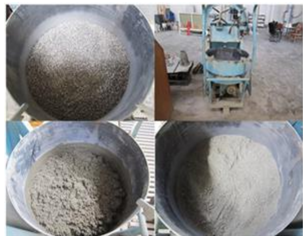
شکل ۳- مراحل تهیه بتن اولیه شامل: میکسر، مخلوط سنگدانه‌ها، مخلوط سنگدانه‌ها و سیمان و مخلوط نهایی بتن تازه
