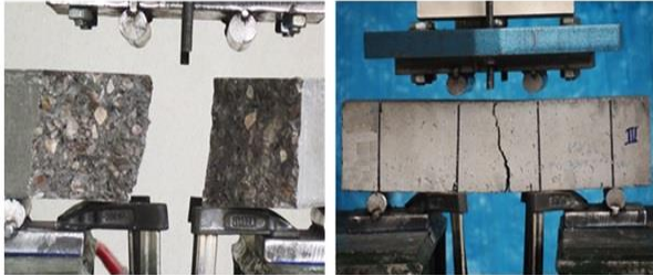
شکل ۲۶- نحوه شکست و جداشدگی سنگدانه‌ها در تیر خمشی ساده
