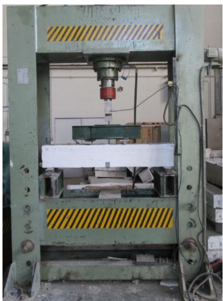
شکل ۱۱- دستگاه بارگذاری و نحوه بارگذاری نمونه‌ها
