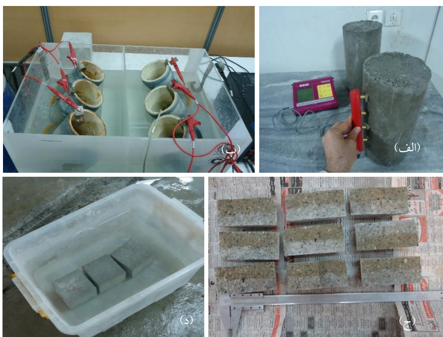
شکل ۱- (الف): مقاومت الکتریکی سطحی، (ب) و (ج): مقاومت تسریع یافته یون‌های کلرایدی، (د): جذب آب حجمی
