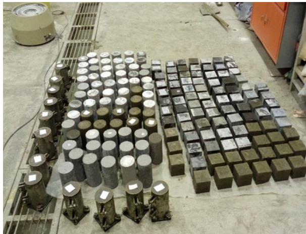
شکل ۳- نمونه‌های مختلف ساخته شده بتن پودری واکنش‌زا جهت مطالعه و آزمایش
