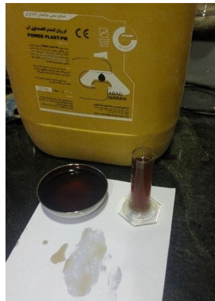
شکل ۲- ابروان کننده و کاهنده قوی آب، به کار رفته در ساخت نمونه‌ها
