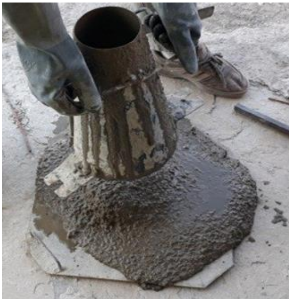
شکل ۶- تصویری از انجام آزمایش اسلامپ پرکننده بتنی
