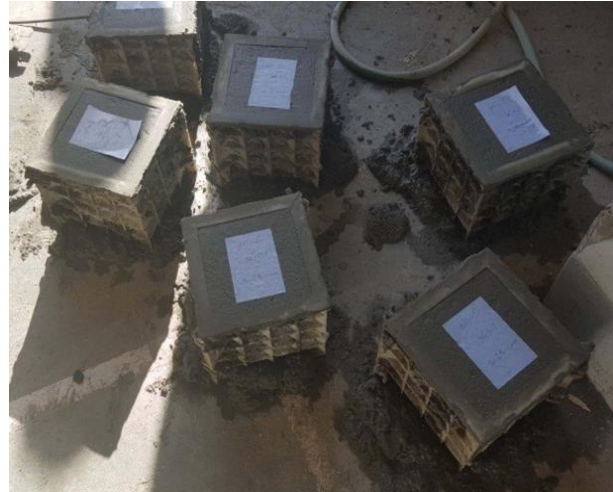
شکل ۴- نمونه‌های مکعبی گرفته شده از پرکننده بتنی هیدرولیکی برای آزمایش مقاومت فشاری
