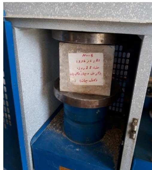
شکل ۵- تصویری از دستگاه آزمایش مقاومت فشاری تک محوره و شکست نمونه در آن
