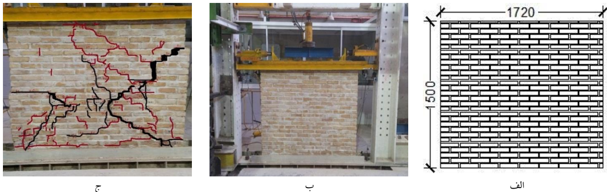
شکل ۴- طرح دیوار، الف) ابعاد دیوار بر حسب میلی متر، ب) هندسه دیوار و شرایط مرزی در آزمایشگاه، ج) دیوار در پایان آزمایش
