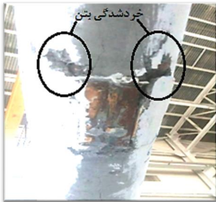
الف- ترک های خمشی و قطری ایجاد شده در نمونه اول ب- خرد شدگی بتن اطراف اتصال RCS در نمونه اول شکل ۷- خرابی های ایجاد شده در اتصال شماره ۱
