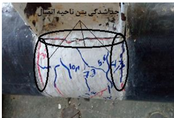
الف- ترک های قطری و خمشی ایجاد شده در نمونه دوم ب- جداشدگی بتن ناحیه اتصال در ناحیه جان تیر شکل ۸- خرابی های ایجاد شده در اتصال ۲
