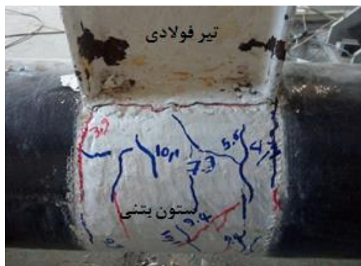
الف- ترک های قطری و خمشی ایجاد شده در نمونه دوم ب- جداشدگی بتن ناحیه اتصال در ناحیه جان تیر شکل ۸- خرابی های ایجاد شده در اتصال ۲
