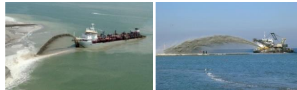
شکل ۳- پمپاژ مصالح حاصل از لایروبی به ساحل و خارج از محدوده لایروبی
