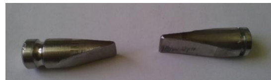
شکل ۲۷- خار قفل کننده در وصله غلاف و گوه
