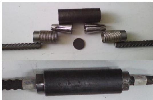
شکل ۱۹- نمونه شماره سه وصله شده به روش غلاف و گوه
