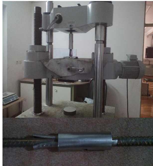
شکل ۱۴- نمونه شماره یک وصله شده به روش غلاف و گوه
