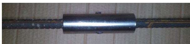
شکل ۱۳- نمونه شماره یک وصله شده به روش غلاف و گوه
