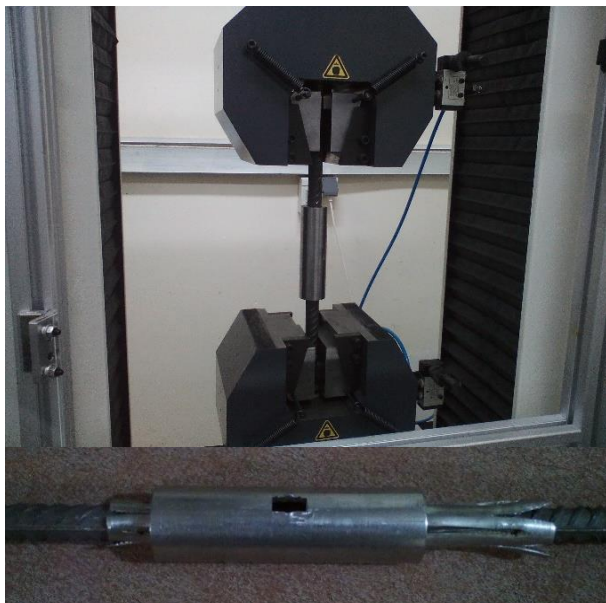
شکل ۱۷- نمونه شماره دو وصله شده به روش غلاف و گوه پس
