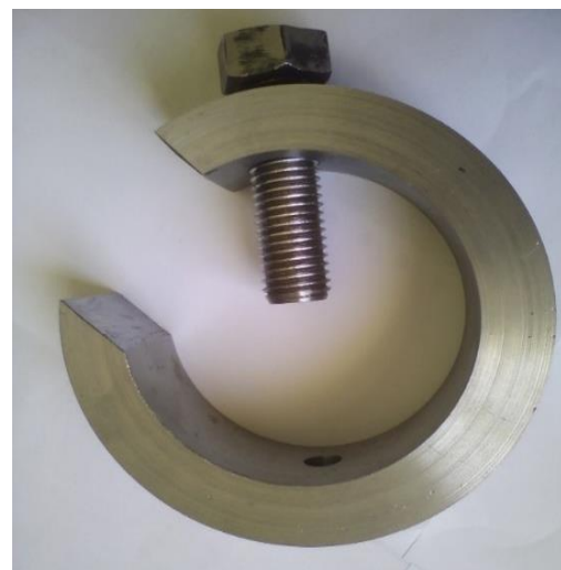
شکل ۲۸- آچار وصله برای اجرای وصله به روش غلاف و گوه
