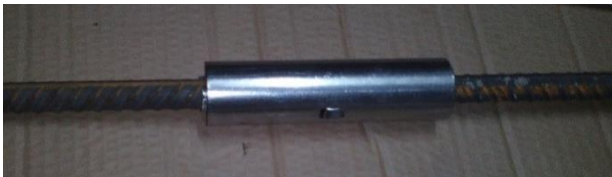
شکل ۱۶- نمونه شماره یک وصله شده به روش غلاف و گوه
