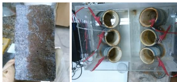
شکل ۵- آزمایش مهاجرت تسریع یافته ی یون های کلرایدی
