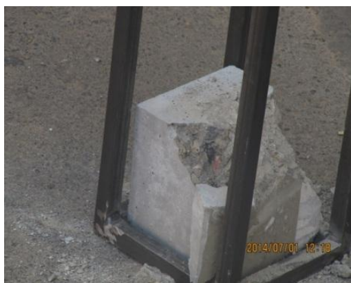
شکل ۲- بتن در حالت گسیختگی نهایی
