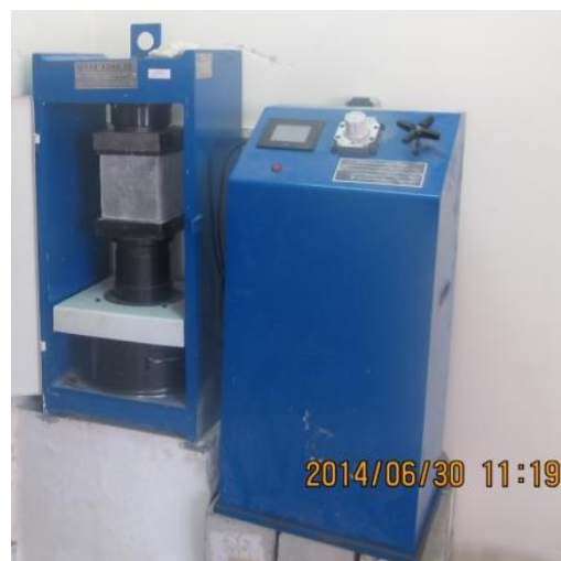
شکل ۵- نمونه‌های مکعبی در حال آزمایش فشاری
