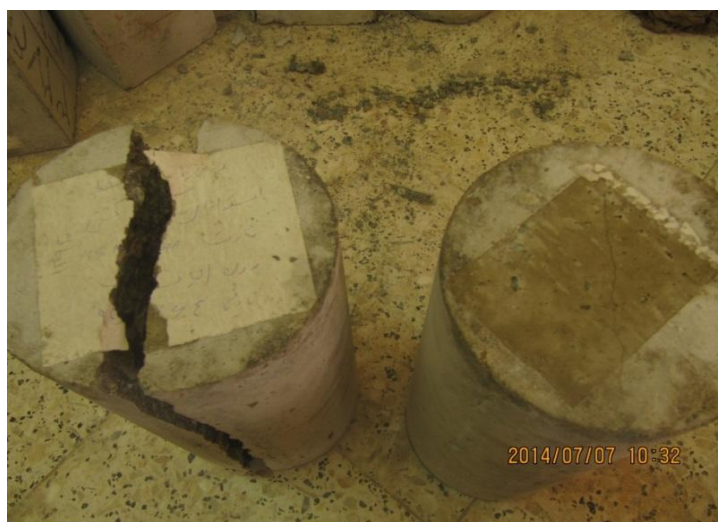
شکل ۹- تأثیر الیاف بر میزان چقرمگی کششی بتن
