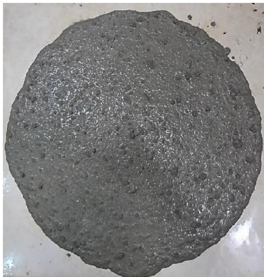
شکل ۶- نمونه‌ای از بتن خودتراکم با اسلامپ مطلوب
