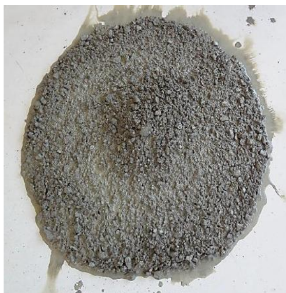
شکل ۷- نمونه‌ای از بتن خودتراکم با اسلامپ نامطلوب
