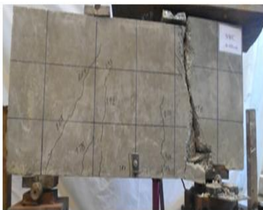
شکل ۶- شکست برشی حاصل از آزمایش و تحلیل الف) نمونه (N-45-0.5) ب) نمونه (L-45-0.5)
