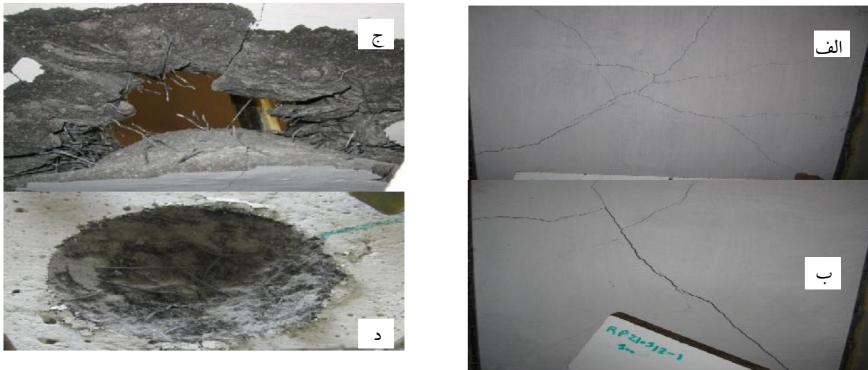
شکل ۸- الف) تشکیل ترک‌های چندگانه در نمونه‌های RP ب) تشکیل ترک‌های موضعی ج) الیاف‌های فولادی جدا شده د) الیاف‌های ترکیبی در دال‌های RHL
