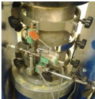
شکل ۹- استفاده از حلقه استاندارد و سنسور تغییر مکان برای
