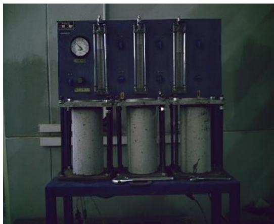
شکل ۴- دستگاه اندازه‌گیری نفوذپذیری (آزمایشگاه بتن دانشگاه تبریز)
