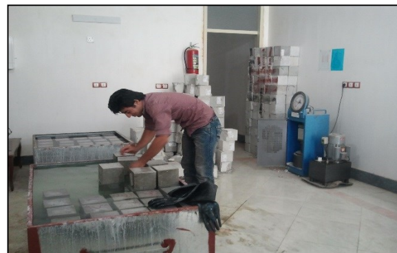
شکل ۵- تصویری از نمونه های بتنی ساخته شده در آزمایشگاه بتن و مراحل عمل آوری آنها
