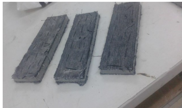
شکل ۳- نمونه‌های مقاومت کششی برش داده شده با ابعاد
