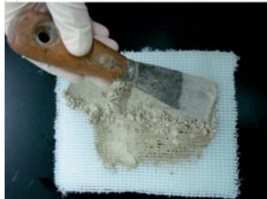
شکل ۲- پر کردن و ویریه پارچه اسپیسر با سیمان و افزودنی
