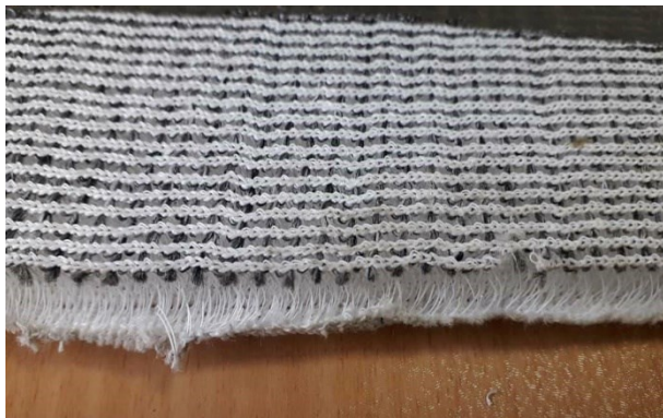
شکل ۱- نمونه‌ای از پارچه اسپیسر تولید شده
