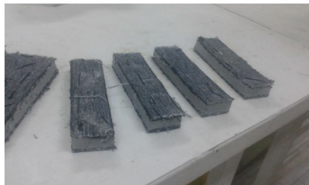
شکل ۴- نمونه‌های مقاومت خمشی برش داده شده با ابعاد
