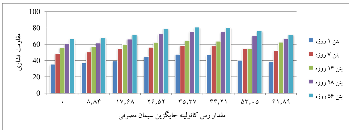
شکل ۳- تاثیر جایگزینی رس کائولینه بر روی مقاومت فشاری بتن در سن های مختلف
