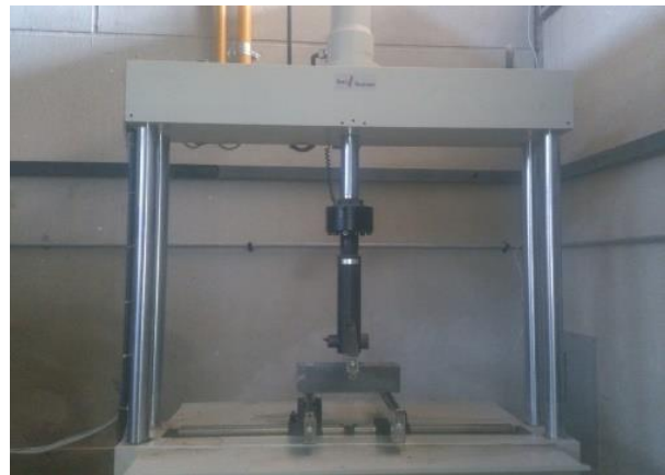
شکل ۳- نحوه انجام آزمایش خمشی تیر منشوری
