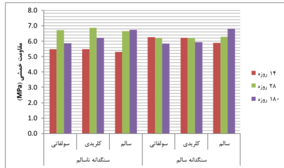
شکل ۱۲- تاثیر محیط بر مقاومت خمشی نمونه‌ها در طول زمان
