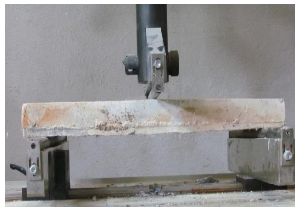
شکل ۴- نحوه انجام آزمایش خمشی دال
