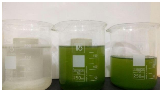
شکل ۱۲- مقایسه (a) نمونه شاهد، (b) نمونه سیمانی بدون ZnO، (c) نمونه سیمانی حاوی ۰/۱ درصد Zn
