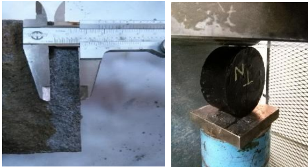
شکل ۳- تعیین عمق نفوذ یون‌های کلراید به روش چشمی
