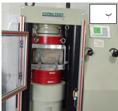
شکل ۴- دستگاه‌های تست مقاومت (الف- جک تعیین مقاومت فشاری ب- جک تعیین مقاومت کششی)
