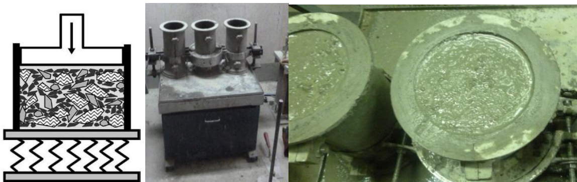
شکل ۳- ساخت و تراکم نمونه استوانه‌ای بتن غلتکی توسط میز لرزان و سربار
