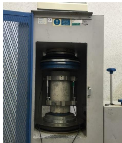
شکل ۴- نحوه قرارگیری نمونه برای تعیین منحنی تنش-کرنش
