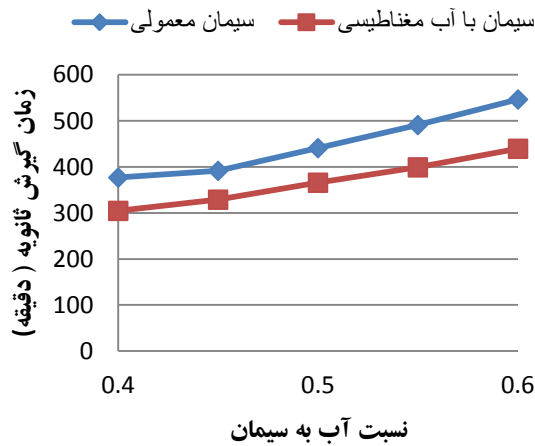
شکل ۳- نمودار تغییرات گیرش اولیه و ثانویه خمیر سیمان معمولی و با آب مغناطیسی با نسبت آب به سیمان
