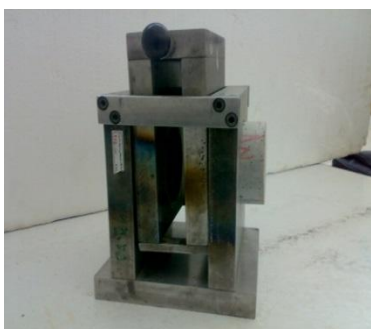
شکل ۷- نمایی از نمونه داخل دستگاه آزمایش برش خالص
