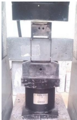
شکل ۶- نمایی از نمونه و نحوه بارگذاری آزمایش برش خالص
