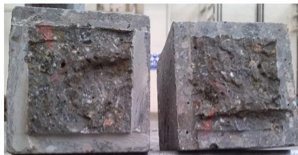
شکل ۸- نمونه‌ای از مقطع شکست نمونه‌های بتنی تحت آزمایش JSCE G553
